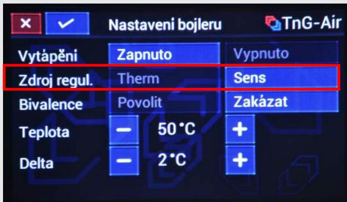
*Therm (termostat)* – Toto nastavení zvolte v případě, kdy teplotu v bojleru reguluje jímkový termostat. V takovémto případě políčky + a - nastavujete teplotu vody v trubkovém výměníku uvnitř bojleru. Ideální pracovní teplota pro toto nastavení je 59 °C.
