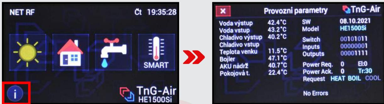
*Voda výstup* – Ukazatel teploty výstupní vody ve °C s přesností na jedno desetinné místo (pouze v případě přítomnosti čidla)
