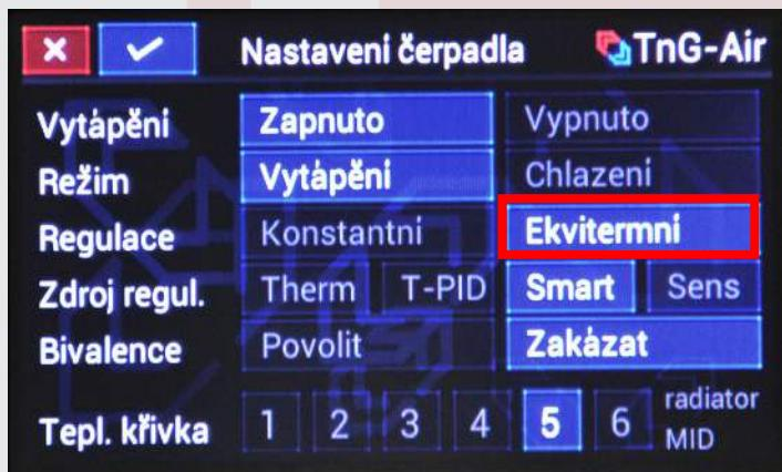
Ekvitermní – Vytápění tepelného čerpadla je nastaveno skrz teplotní křivku\*. Teplotní křivku nastavíme v 6 úrovních. 1 – 3 pro podlahové topení, kdy 1 je nejekonomičtější nastavení teplotní křivky a 3 nejvýkonnější nastavení teplotní křivky. 4 – 6 pro radiátorový topný systém, kdy 4 je nejekonomičtější nastavení teplotní křivky a 6 nejvýkonnější nastavení teplotní křivky.
