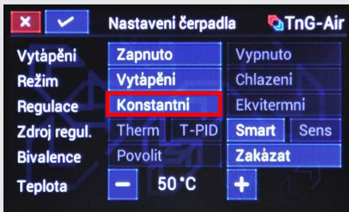
Konstantní – Vytápění nebo chlazení tepelného čerpadla je nastaveno na jednu výstupní teplotu. Nastavení konstantní teploty nastavíte pomocí + a -. Pro ekonomický chod tepelného čerpadla nenastavujte vyšší výstupní teplotu než 50 °C v režimu vytápění a nižší než 12 °C v režimu chlazení.
