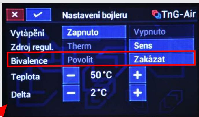
*Delta* - Jedná se o rozsah teplot, ve kterém se ohřev bojleru bude pohybovat a na základě, kterého bude tepelné čerpadlo spínat a vypínat.
