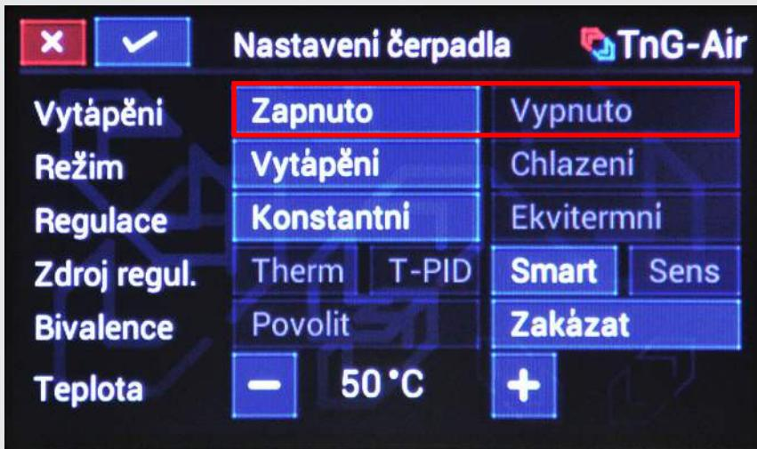
*Zapnuto* – Vytápění tepelného čerpadla je zapnuto
